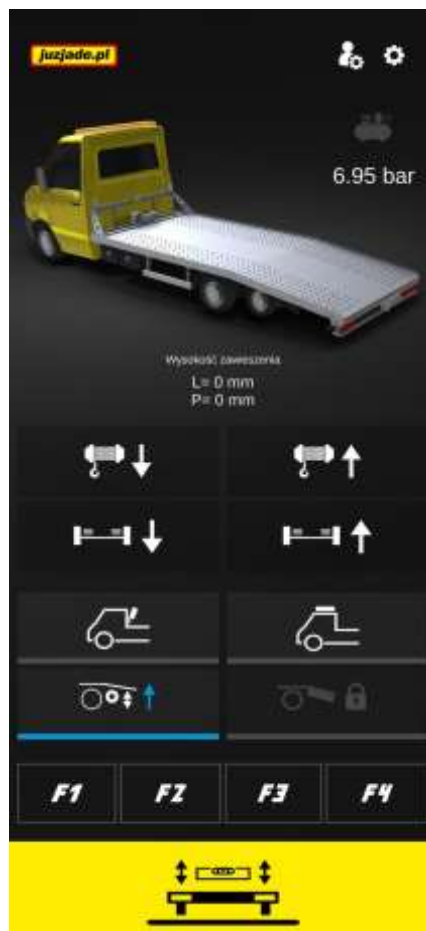
SELBSTNIVELLIERUNG BEIM FAHREN MIT ERHOBENEM ANHÄNGER, AKTIVIERT. DIE APP ZEIGT EINEN REFERENZPEGEL VON 0 IN MILLIMETERN AN (ZIELT AUF 0 MM AN)
