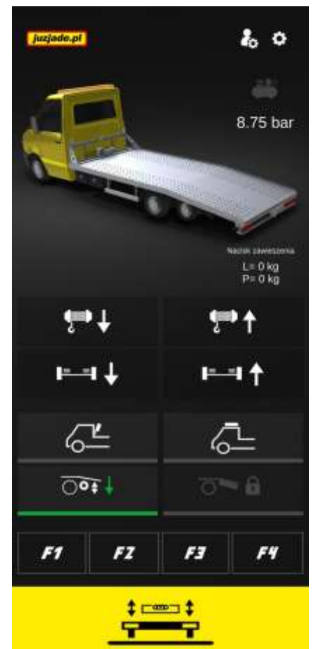
SELBSTNIVELLIERUNG BEIM FAHREN MIT DEM ANHÄNGER UNTEN AKTIVIERT. DIE APP ZEIGT DEN DRUCK AUF DEN ANHÄNGER IN KILOGRAMM AN (SIE ZIELT AUF 750 KG AN).
