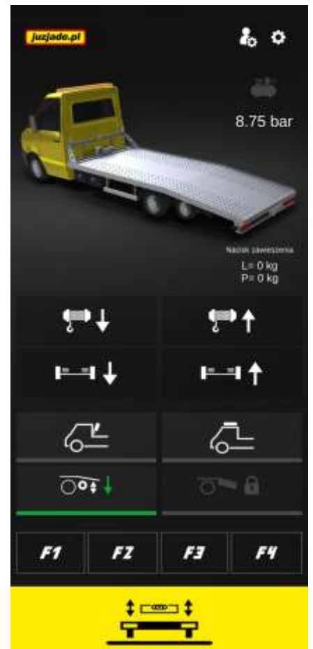
SAMO-POZIOMOWANIE DO JAZDY Z OPUSZCZONĄ PRZYCZEPKĄ WŁĄCZONE. APLIKACJA WSKAZUJE NACISK NA PRZYCZEPKĘ W KILOGRAMACH (DĄŻY DO 750 KG)
