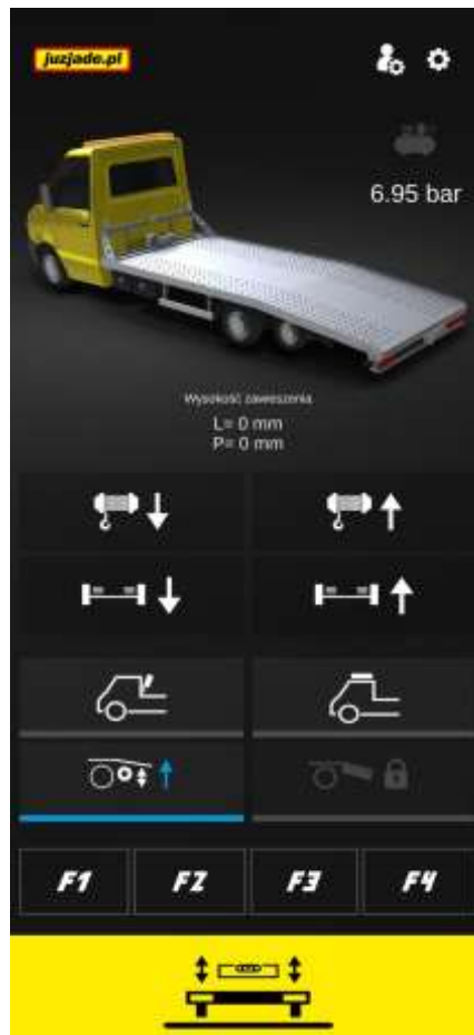
SAMO-POZIOMOWANIE DO JAZDY Z UNIESIONĄ PRZYCZEPKĄ WŁĄCZONE. APLIKACJA WSKAZUJE POZIOM ODNIESIENIA DO POZIOMU 0 W MILIMETRACH (DĄŻY DO 0 MM)
